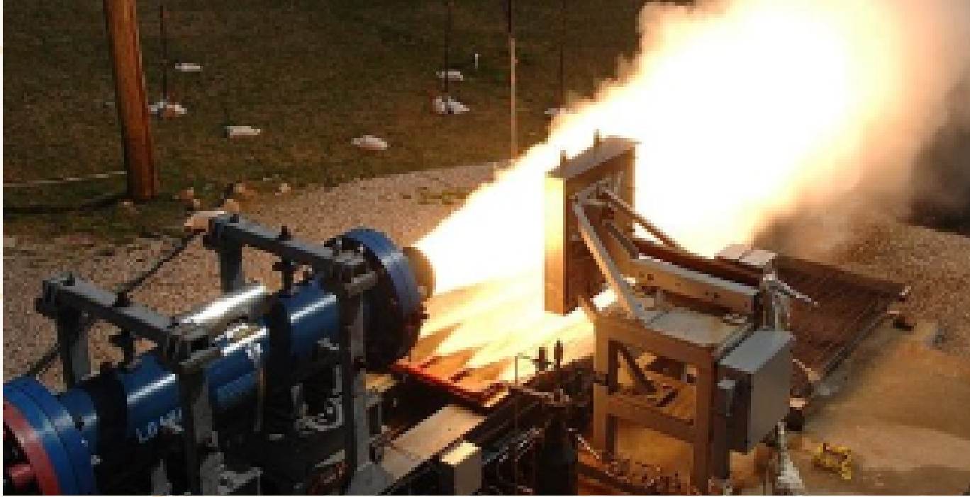
NASA SLS Roketine Yalıtım Malzemesi Denemesi
