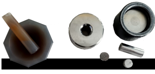
Şekil 3 : Toz NaHCO 3 dan pellet şeklinde NaHCO 3 hazırlamak için kullanılan pellet
