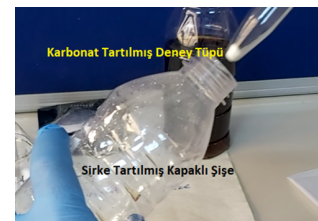
Şekil 3 : Kapaklı basınca dayanıklı ortamda reaksiyon.
