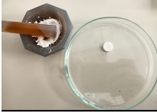
Şekil 5 : Ağat havan içindeki ince toz halindeki NaHCO 3 ın pellet haline gelmiş şekli
