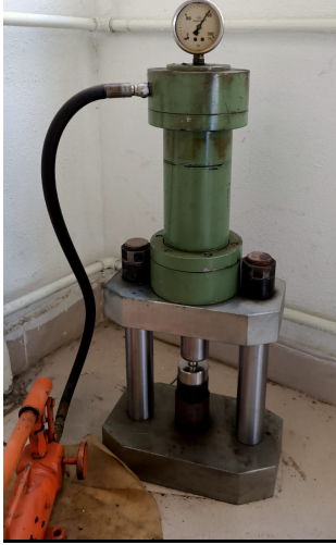
Şekil 4 : Toz numuneleri pellet haline getirmek için yüksek basınç sağlayan hidrolik pres.
